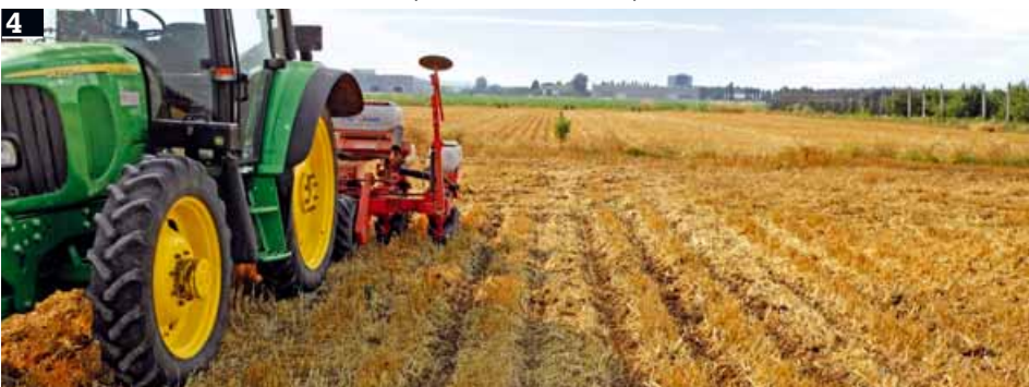
Foto 3 e 4 La larghezza della striscia lavorata deve essere di dimensioni commisurate all'elemento di semina (3). L'elemento della seminatrice che opererà sulla fascia lavorata è preferibile che sia dotato di utensili sparti-residuo al fine di poter allontanare senza difficoltà eventuali residui presenti sulla striscia, specialmente nel caso di semina di colture intercalari, dove l'intensità della lavorazione viene ulteriormente ridotta allo scopo di contenere le perdite di umidità (4)
