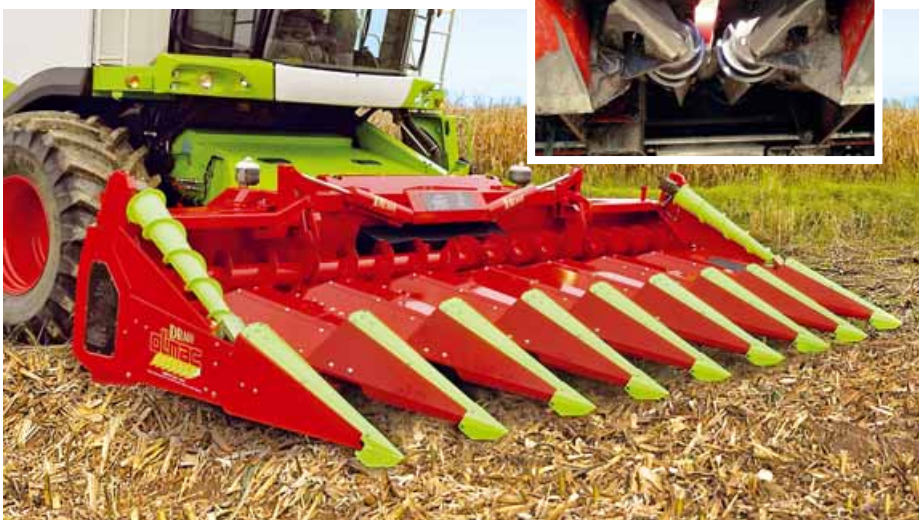
Foto 1 In uno spannocchiatore efficiente deve essere possibile regolare la velocità dei rulli mungitori (nel dettaglio ) e la distanza delle piastre alla dimensione degli stocchi e all'altezza delle pannocchie
