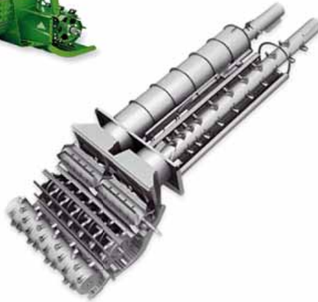
Foto 9 Apparato trebbiante ibrido: si nota la presenza del sistema battitore/controbattitore, come nelle convenzionali, e dei due rotori paralleli all'asse della macchina, come nelle assiali
