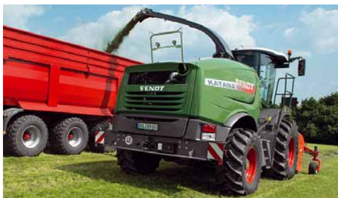
Sulla Katana 65 viene proposto il motore Mercedes Benz OM473 LA R6 da 626 CV, Tier 4f
